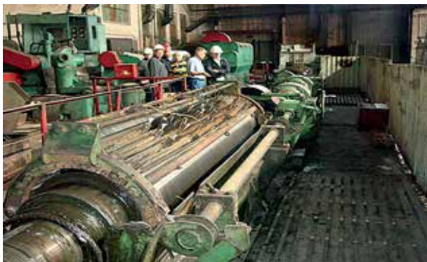
Установка для текстурування листопрокатних валків станів на заводі «Запоріжсталь», працює з 1973 р. по теперішній час
