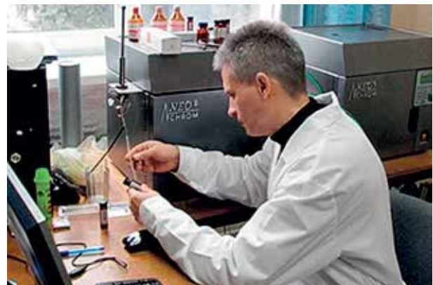
Дослідження зразків металів рентгено-спектральним методом
