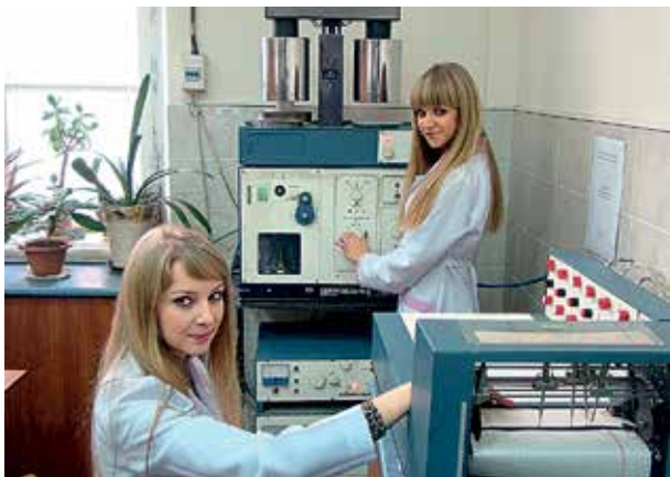
Визначення термогравіметричних параметрів вугілля на дериватографі
