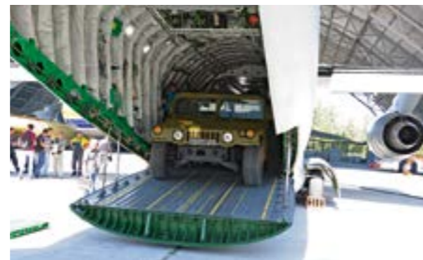
Тестування завантаження техніки в Ан-178
