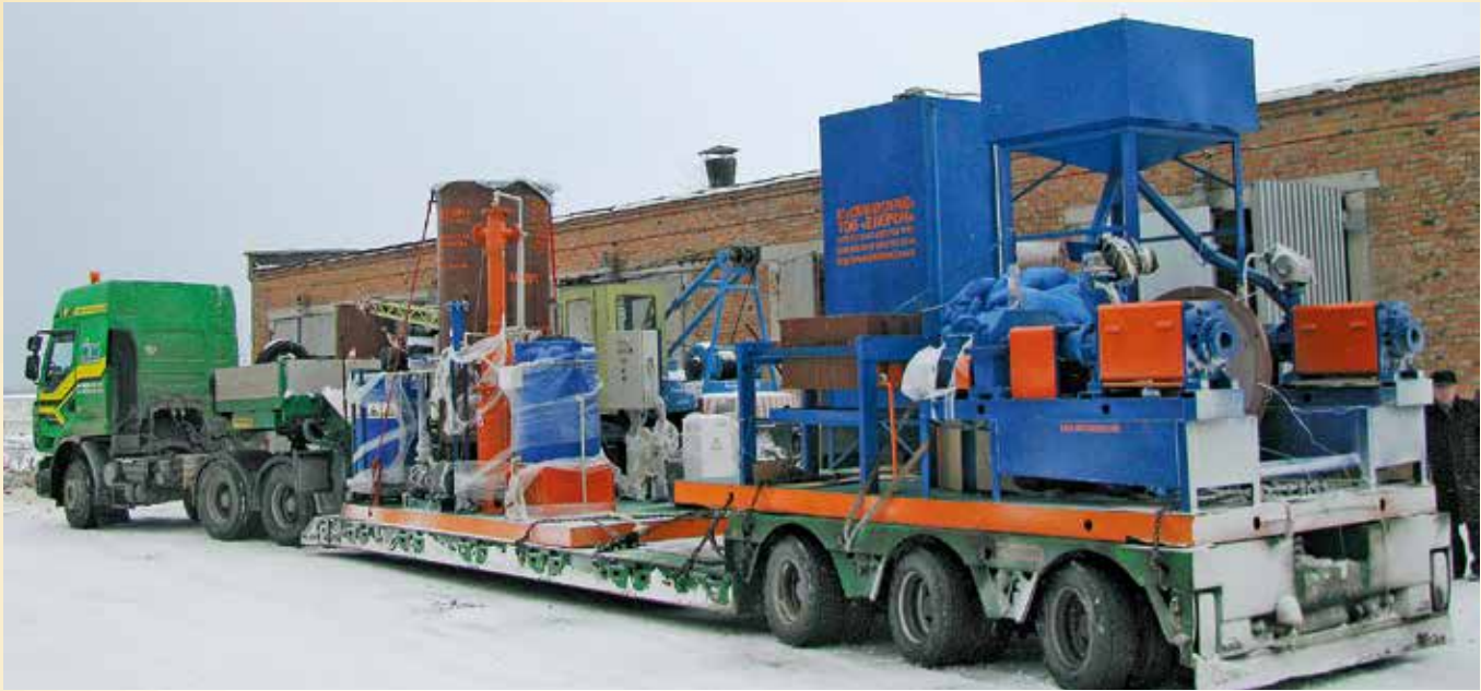
Автоматизований міні-завод для виробництва дизельного біопалива
